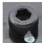
optische Kontrolle nach einer markierten Drehmomentverschraubung
