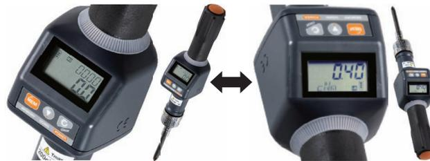
[Bsp.] Weitere Einsatzmöglichkeit des STC2-G: Kontrolle des eingestellten Wertes eines Drehmoment-Schraubendrehers
