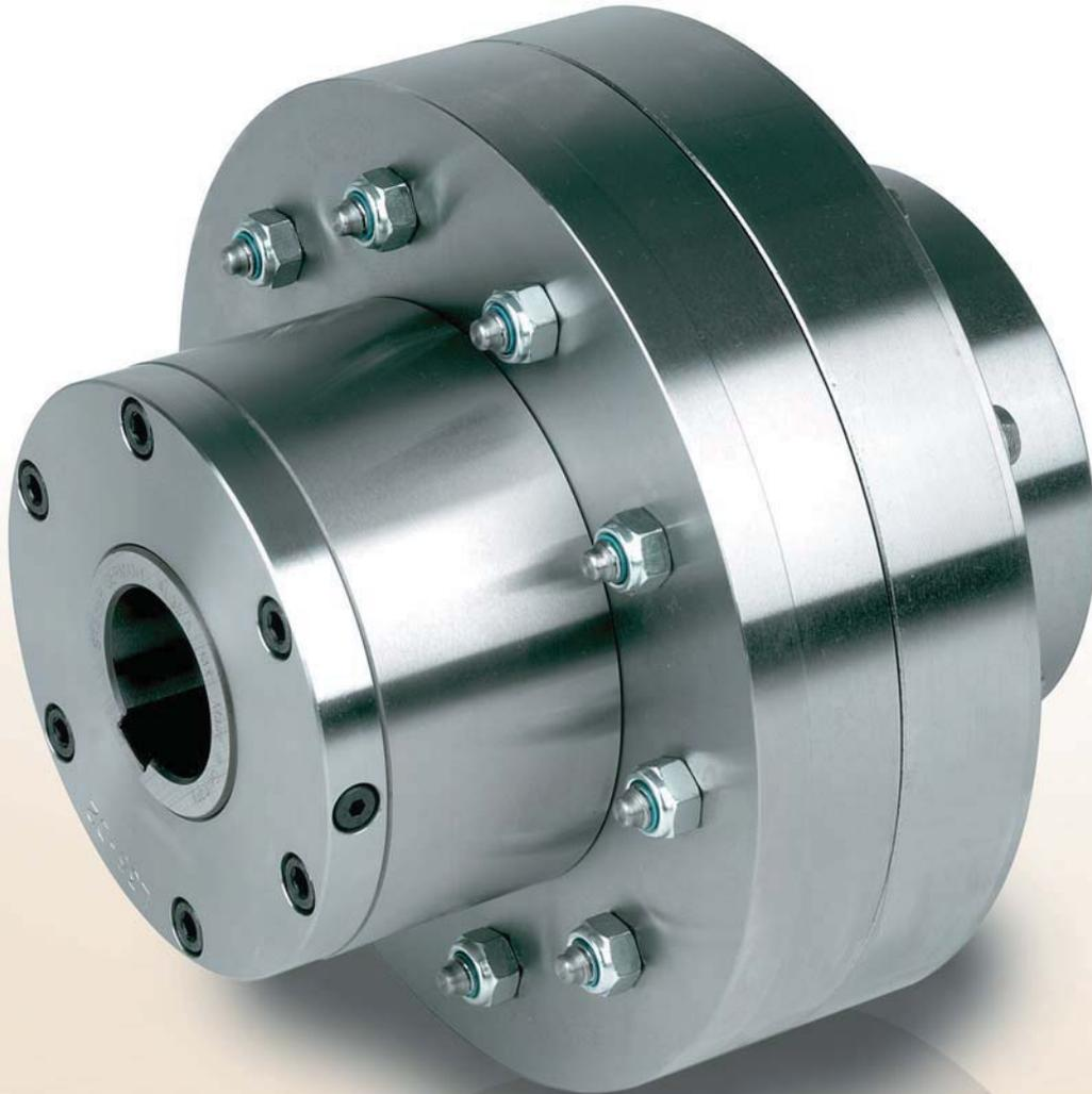
Die Bauart AL..KEED2 ist ein abgedichteter, montagereif gefertigter Rollenfreilauf, in sich gelagert mit zwei Kugellagern der Reihe 160.. Die Lieferung erfolgt mit Ölfüllung.
