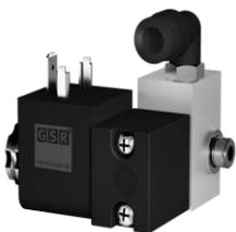
3/2-Wege direktgesteuert, NC G1/8, Sitz 1,5mm, 0-8 bar Aluminium / Edelstahl / FKM mit Cnomo-Antrieb sowie integrierter Verschraubung zur einfachen Montage
