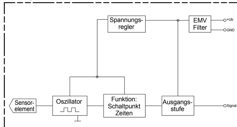
**Funktionsdiagramm für MAXIMUM Sonden**
