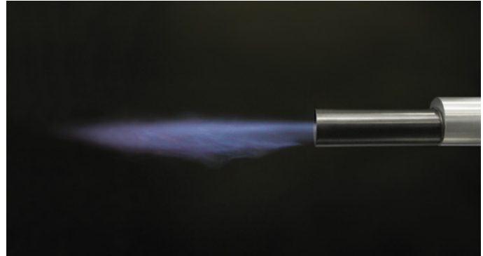
Flamme des ZKIH bei Erdgasbetrieb im Freibrand
